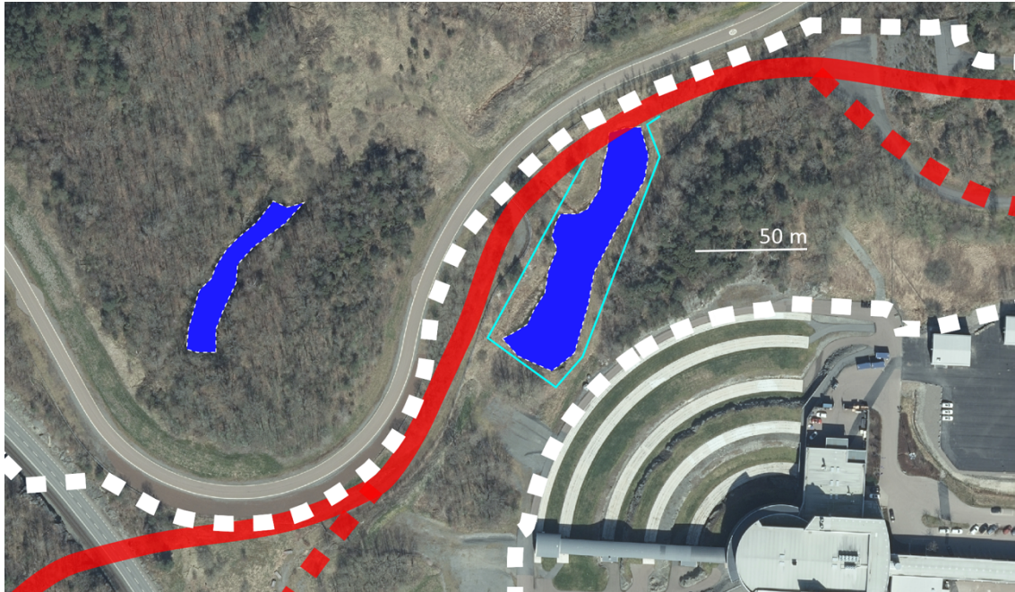
Figur 2. Karta över tillfartsväg med damm och skärmar. Övervintringsområden för amfibier avskärmas med plastskärm (ljusblå linje).
