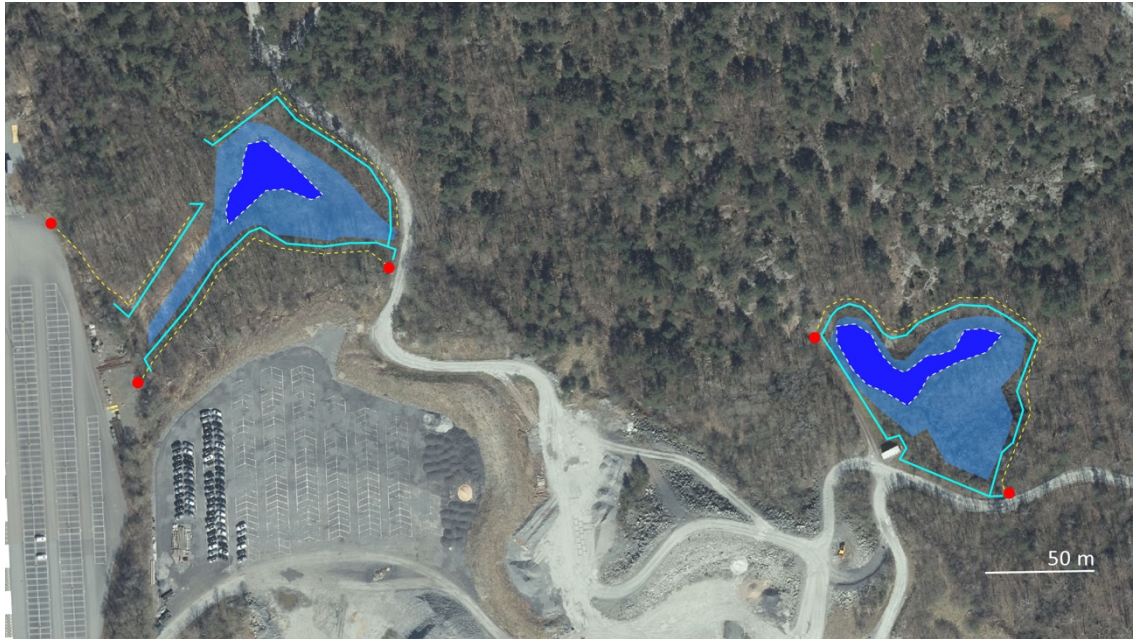
Figur 5. Dammar inom planområdet med omgivande våtmark inom planområdet med plastskärmar som hindrar groddjur att nå dammarna. Ljusblå ytor markerar våtmarker och mörka blå visar dammar/öppen vattenspegel. Blå linje anger avskärmade plastskärmar. Gula streckade linjer anger körvägar för arbetsfordon. Röda punkter angöringspunkter för arbetsfordon.
